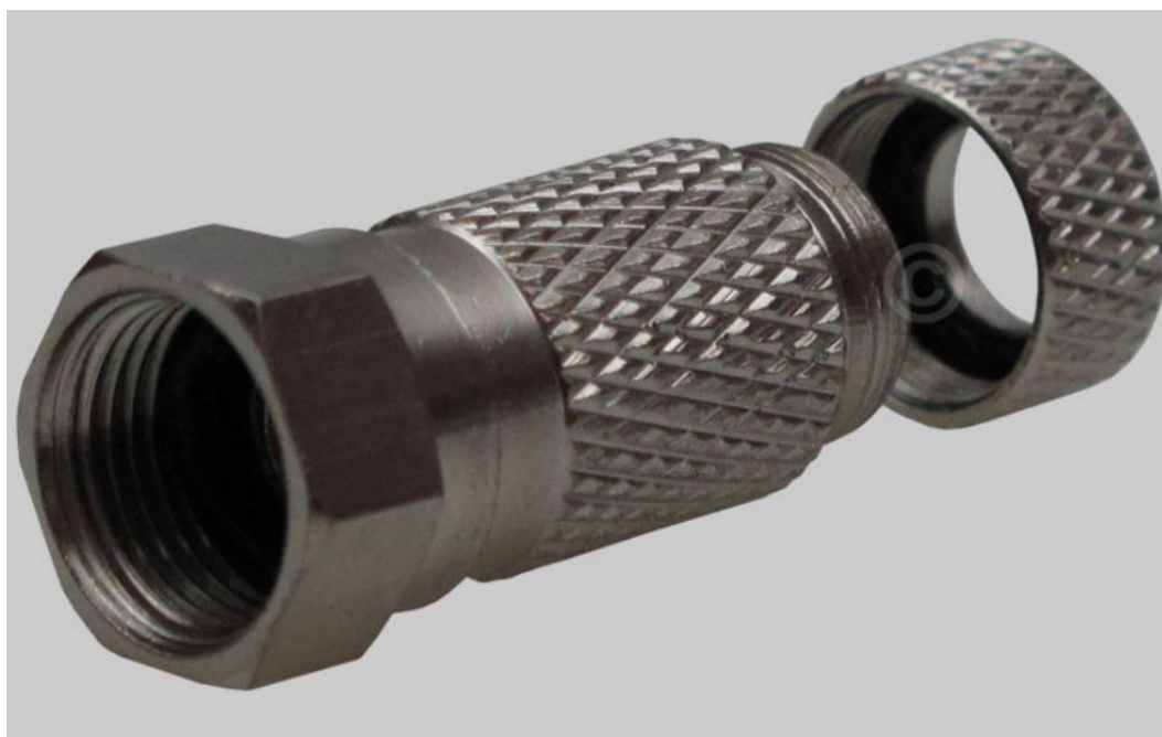
Figuur 8: waterdichte F-plug; zowel in de zeskante moer als in kartelmoer zit een O-ring
