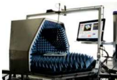
De meetopstelling waarmee hogere frequenties van draadloze systemen kunnen worden gemeten. Foto: Bart van Overbeeke
