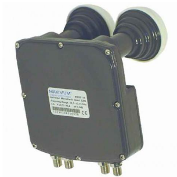
Monoblock 6 graden Hotbird-Astra 1 met een onderlinge h.o.h.-afstand van 65mm. Hier staan de twee feedhorns los van elkaar.
