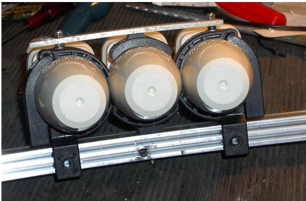
Een oplossing om Alps-lnb's dicht bij elkaar te zetten
