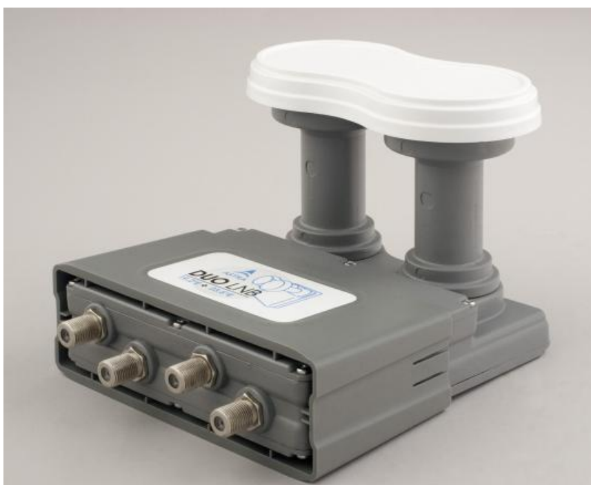
Een duo-lnb 4,3 graden voor een 80cm schotel waarvan de twee lnb's 53mm uit elkaar staan. De twee feedhorns raken elkaar nog wel.
